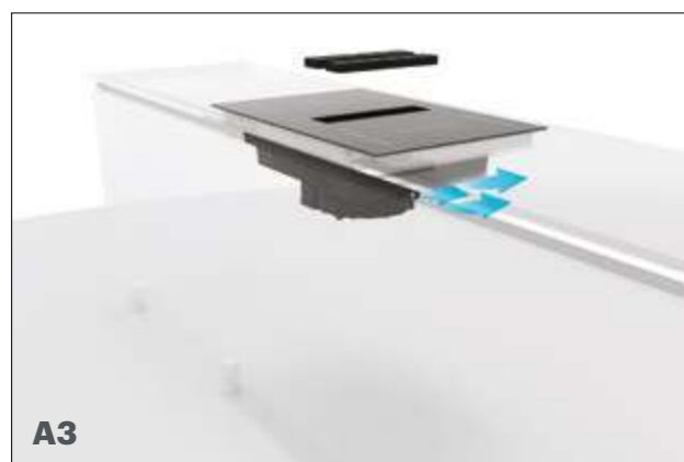
A3 INSTALLAZIONE FILTRANTE CON FILTRO LONG LIFE CON SCARICO ARIA SU VUOTO SANITARIO Cod. 005PRC054000
